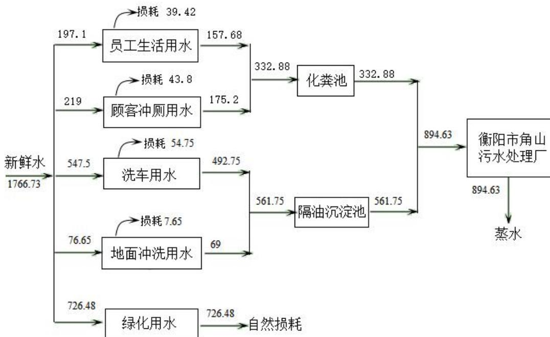
图 2-1: 项目水平衡情况 单位: m<sup>3</sup>/a
